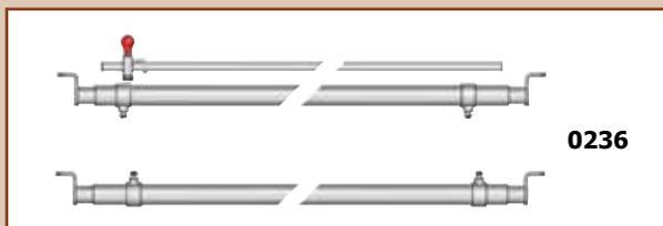
Steht ein \* hinter der minimalen Länge, kann das Bauteil mit Säge oder Winkelschleifer gekürzt werden. Eventuell müssen Löcher gebohrt werden.
