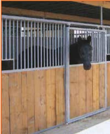
Die **Komfortlinie** verdankt ihren Namen ihrer schnellen und einfachen Aufbauweise. Die Boxen werden nach einer Rahmenbauweise erstellt. Das heißt, jede Boxenwand wird in einem Stück aufgebaut. So fallen die üblichen Säulen weg. Die Trennwände und Vorderfronten werden mit Verbindungsstücken direkt verschraubt. Nur am Ende einer Boxenreihe ist ein Eckpfosten erforderlich.
