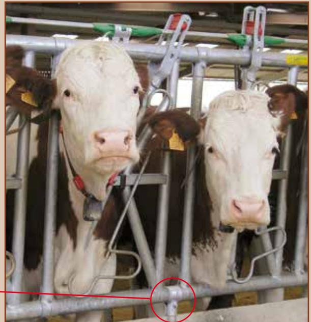
Fressgitter ab vier Meter mit Stützstrebe
