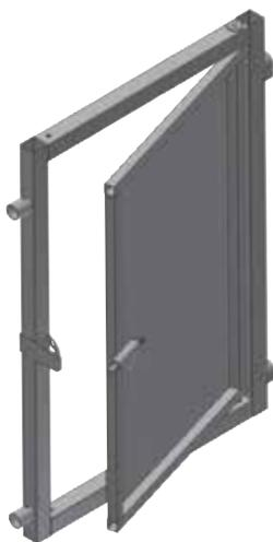
Für einen schnelleren und besseren seitlichen Zugang ans Tier. Rahmen der flexiblen Seitentür wird einfach statt der Rohre seitlich in die unterste und oberste Rohraufnahme eingehängt. Durch das wechselbare Scharnierrohr und den wechselbaren Riegelhalter, kann die Tür an beiden Seiten, jeweils vorne und/oder hinten, eingehängt werden. Die Seite, nach welcher die Tür aufgeschlagen werden soll, kann so frei gewählt werden.
