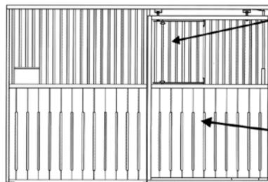
Schiebetür mit aufschwenkbarem Gitter optional
