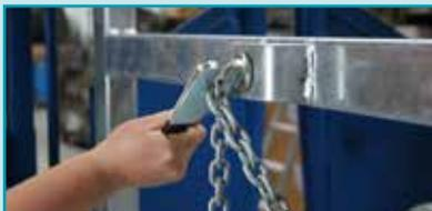
Alle **Kettenverschlüsse** entriegeln mittels Auswurfhebel bei geringem Kraftaufwand, auch unter Last.
